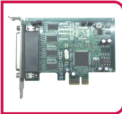
PCIe插槽专用的4个串口卡
