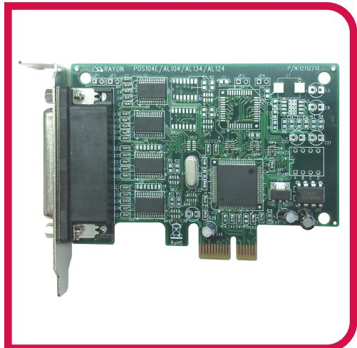
PCIe插槽专用的4个串口卡
