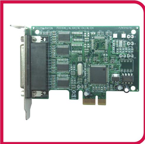
PCIe插槽专用的4个串口卡
