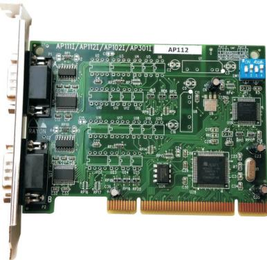
PCI插槽专用的2个串口卡
