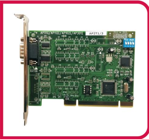
PCI插槽专用的2个串口可监控卡
